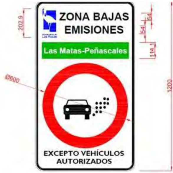
Ilustración 29. Señalética de sectorización y puerta de entrada
