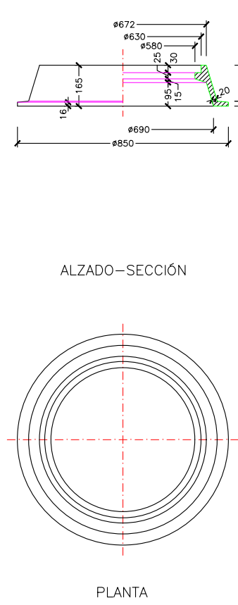
CERCO PARA POZO DE REGISTRO EN CALZADA SIN ESCALA COTAS en Milímetros
