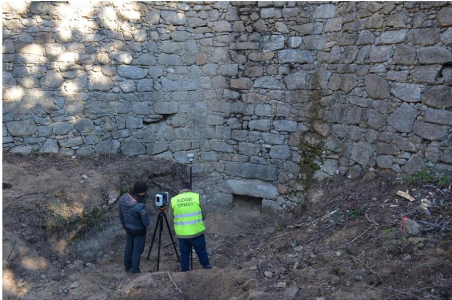
Figura 25: trabajos de fotogrametría en la alcantarilla del barranco bajo el acueducto.
